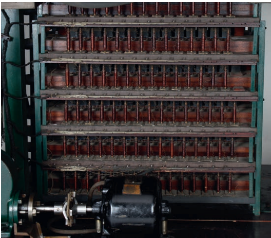
Bild 8 – Motor und Schneckengetriebe für die Aufwickelspule
