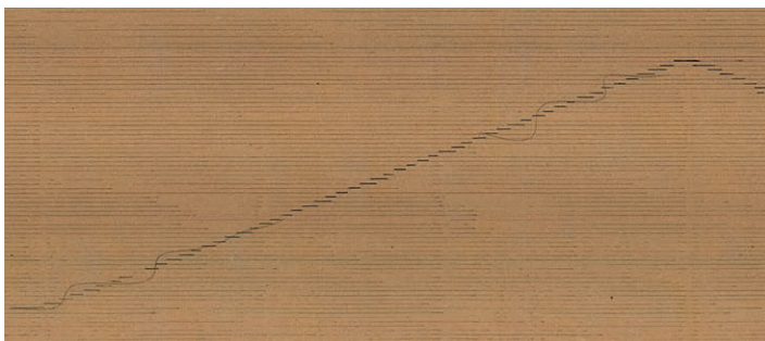
Bild 19 – Tonleiter-Test zu Beginn einer Rolle. Das Rädchen, das den neunten Ton hätte markieren sollen, hat offenbar nicht funktioniert: Es ist keine Tintenmarkierung vorhanden.
