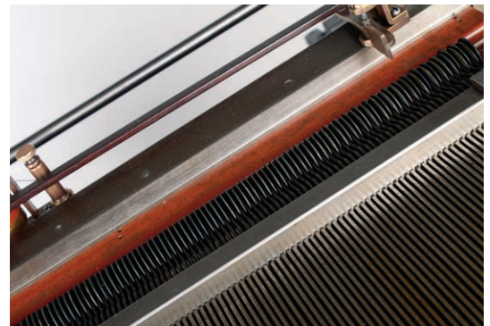
Bild 15 – Eine Reihe von Rädchen an der Umlenk-leiste
