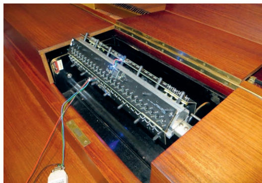
Bild 19 – Elektromechanischer Gleitblockaufsetzer der BFH-TI mit Datenbus-Schnittstelle (in Bau)
