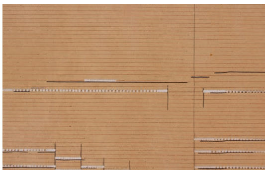
Bild 21 – seitliche Verschiebungen der Tintenmarkierungen, verursacht durch den von Papierkantenfühlern ausgelösten Zentrierungsmechanismus
