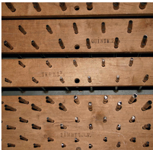
Bild 16 – Orgelpfeifen auf der Windlade der Orgel
