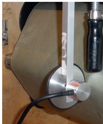
Bild 70 – Wegmessung auf dem pneumatischen Bandspielapparat
