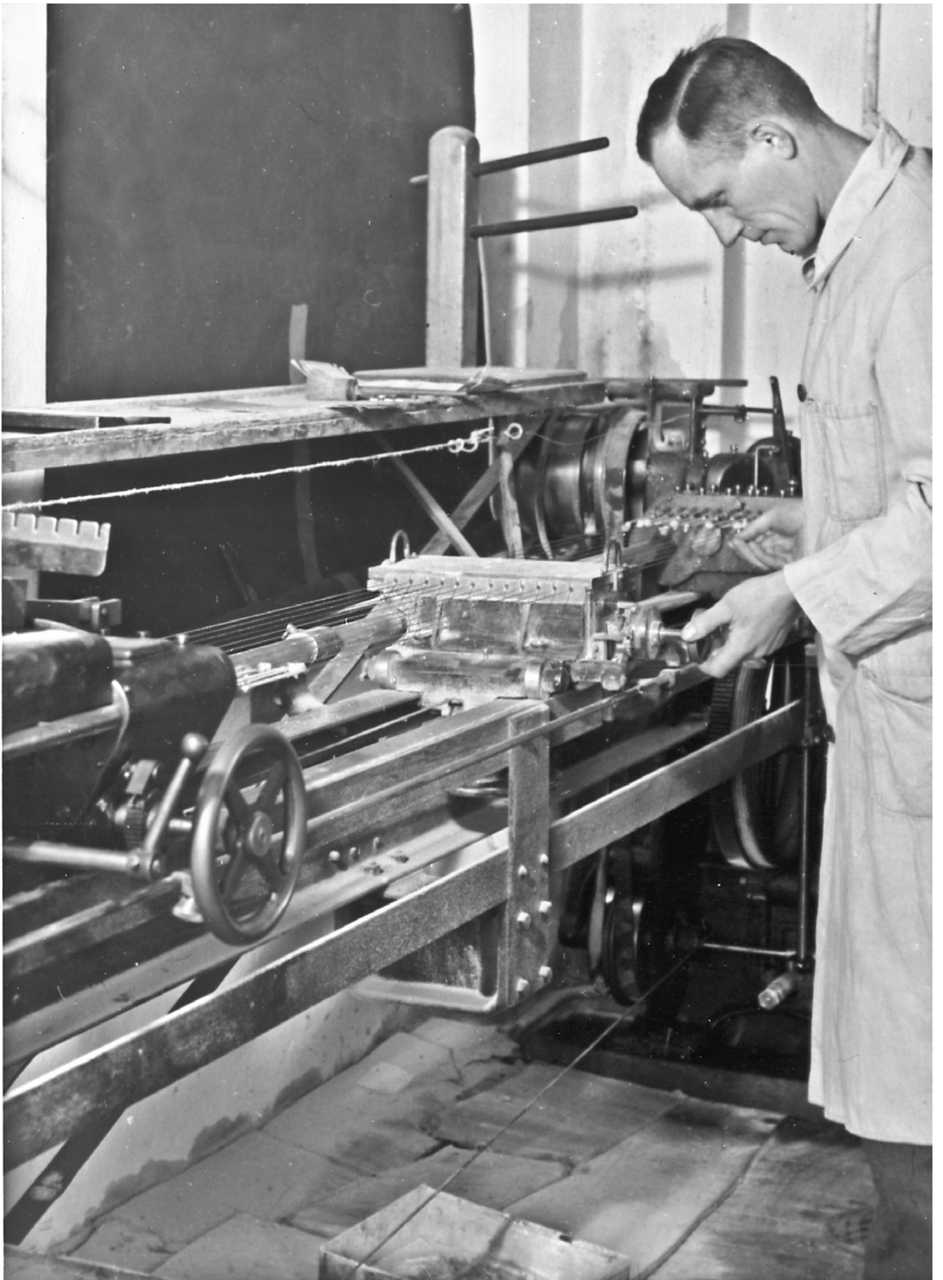
Karl Geipel (Vater von Wilhelm Geipel) an der Saitenschleifmaschine (Foto von Erich Schneider, 1930)
