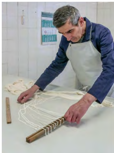
Abbildung 3: Einziehen der Saiten (aus Geipel: Saiten- und Catgutherstellung , S. 14)
