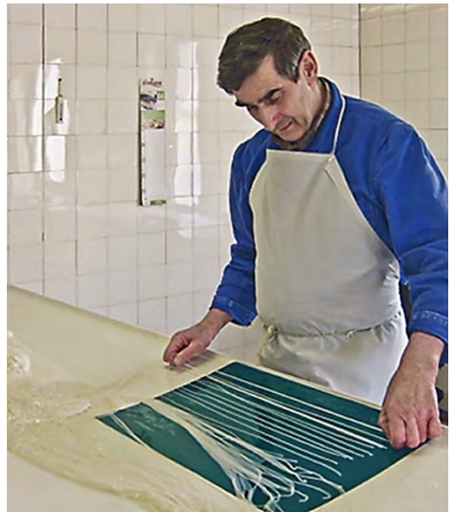
Abbildung 5 (links): Handschleimen mit einem »Schleimblech«
