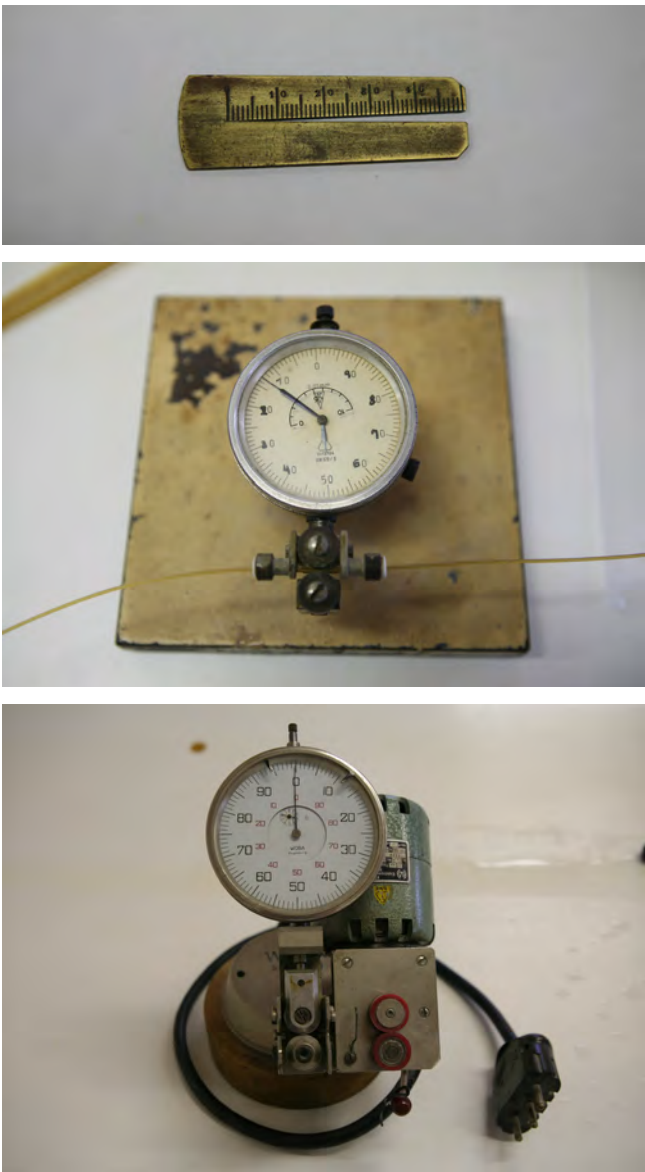
Abbildung 12: Messlehre (oben links), Messschrauben (oben rechts) Messuhr mechanisch (Mitte), Messuhr elektrisch (unten links), Messuhr elektronisch (unten rechts) (Fotos: Bernhard Kainzbauer)
