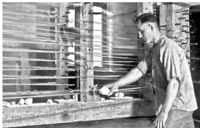
Abbildung 12: Saitenmachermeister Ernst Geipel jun. beim Handschleifen mit Bimsstein, um 1930 (Geipel: Saiten- und Catgutherstellung , S. 27)
