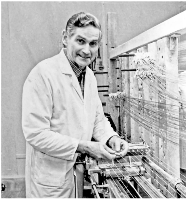
Abbildung 13: Saitenmachermeister Gerhard Frank beim Schleifen der Saiten an der 12-Spindel-Schleifmaschine der Firma Berthold, 1987 (Geipel: Saiten- und Catgutherstellung , S. 29)
