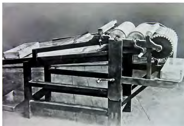
Abbildung 6: Frühes Modell der Schleimmaschine (Darmreinigungsmaschine) von Seckendorf, Schreiber und Huster (Geipel: Saiten- und Catgutherstellung , S. 14)
