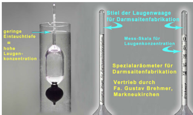
Abbildung 4: Laugenwaage für die Darmsaitenfäbrication (Geipel: Saiten- und Catgutherstellung , S. 13)
