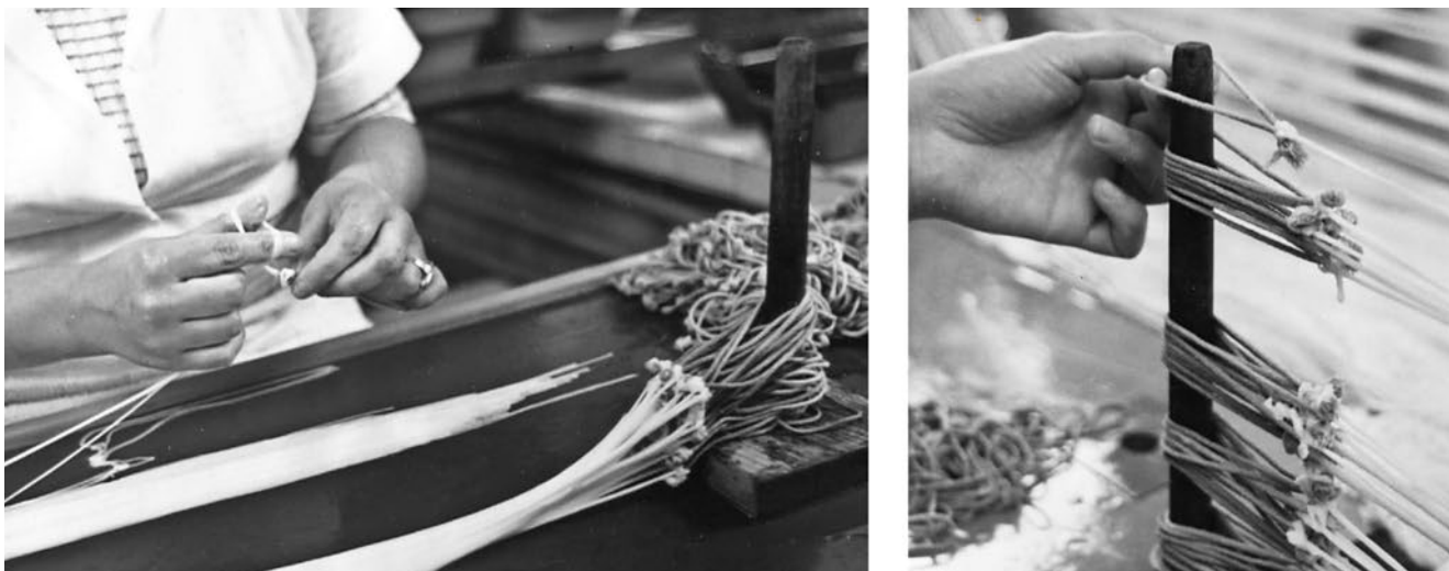
Abbildung 8: Vor- und Anschlingen (aus Geipel: Saiten- und Catgutherstellung , S. 23)
