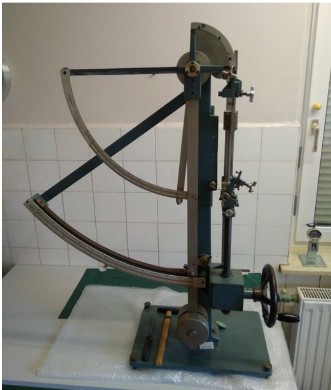
Abbildung 13 (links): Mit der Zugprüfmaschine wird stichprobenweise die Haltbarkeit der Saiten getestet.
