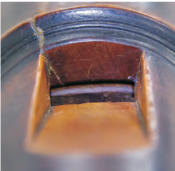
ABBILDUNG 17 Foto von der ›Nordwand‹ und den Fasen am Windkanalausgang bei der Altblockflöte. Die sehr schön geschnittenen Fasen sind vielleicht nicht mehr makellos glatt, aber ihre Kondition ist doch ausgezeichnet zu nennen.
