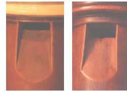
ABBILDUNG 19 Zwei Labien mit asymmetrisch gestochenen Seitenwänden bei Altblockflöten von Terton. Wie auf beiden Fotos zu sehen ist, ist immer die rechte Wand schiefer gestochen als die linke. Links: Altflöte in der Dayton C. Miller Collection, Library of Congress, Washington DC (Inv. Nr. 871); rechts: Altflöte im Musikinstrumentenmuseum Brüssel (Inv. Nr. 1038).
