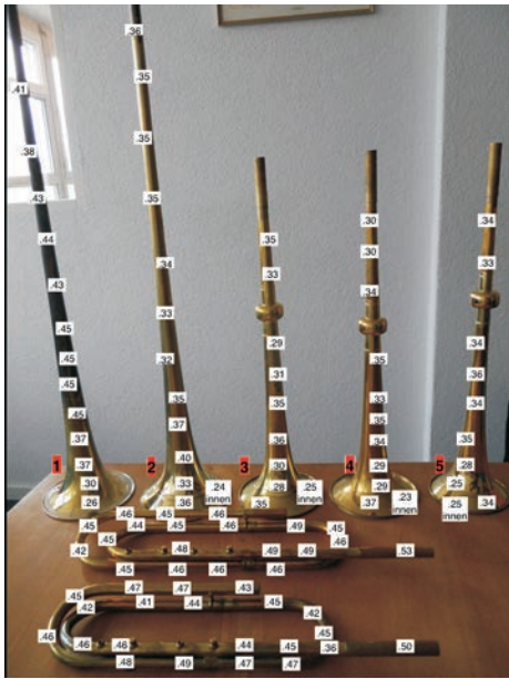
ABBILDUNG 4 Fünf Schallstücke der Firma Egger, Basel. Ausgangsblechdicken: 0,45 mm für Nr. 1, 0,40 mm für die Nr. 2–5. 2 Steckbögen aus 0,50 mm-Blech
