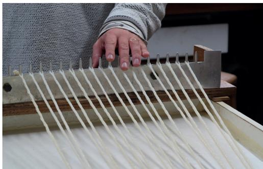
Historisch informierte Saitenherstellung in der Werkstatt von George Stoppani (Manchester): Aus einzelnen Darmstücken wird in einem mehrstufigen Drehprozess eine Saite hergestellt. (Bild: Jane Achtman)
