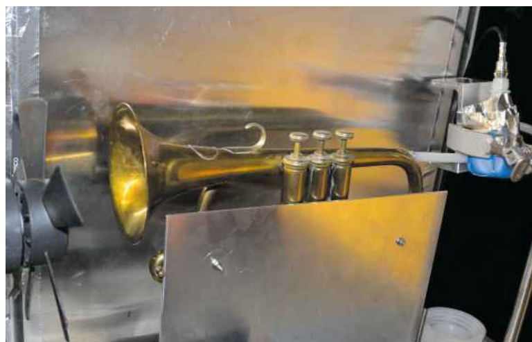
In dieses Kornett wurde atemfeuchte Luft eingebracht (rechts), danach mit Ventilator (links) getrocknet. Neutronenbilder machten die Feuchte im Innern sichtbar.
