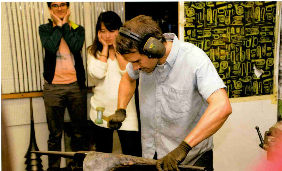
Alex Schölkopf bearbeitet den Rohling einer Barockposaune.
